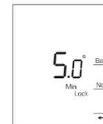
5. En mode verrouillage seulement : Limite maximale de la température du plancher seulement (par défaut : 36 °C).
