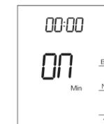
10. Temps minimum OFF Définit le temps minimal pour lequel la sortie peut être éteinte. 0, 30 secondes, 1, 2, 3, 4, 5 minutes (par défaut : 0).
