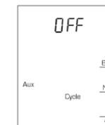
9. Temps minimum ON Définit le temps minimal pour lequel la sortie peut être activée. Utilisé avec les systèmes au gaz ou à l'huile avec une purge. Le temps minimum ON ne devrait être plus court que la durée de la purge. 0, 30 secondes, 1, 2, 3, 4, 5 minutes (par défaut : 0).
