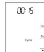
8. Longueur du cycle de la seconde sortie Sélectionner la longueur du cycle selon la charge connectée. 15 secondes, 5, 10, 15, 20, 25, 30 minutes.
