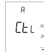
7. Longueur du cycle de la sortie principale Sélectionner la longueur du cycle selon la charge connectée. 15 secondes, 5, 10, 15, 20, 25, 30 minutes.
