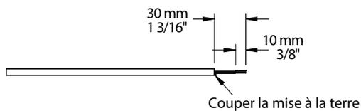
5.2 Insérer la bague de serrage 3 x 10 dans les fils dénudés et ensuite serrer la bague de serrage pour s'assurer que la connexion mécanique soit solide (les fils peuvent être torsadés).
