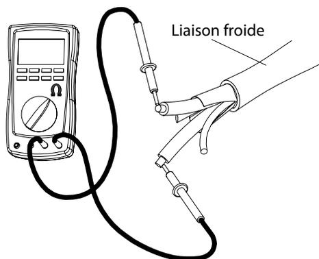
Multimètre d'isolement de type « Megger »
