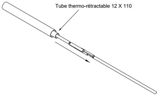
3.1 Chauffer le tube thermo-rétractable sur toute sa longueur avec un pistolet à air chaud (ne pas le surchauffer), s'assurer que le tube est bien rétréci et que du scellant déborde de chaque côté.
