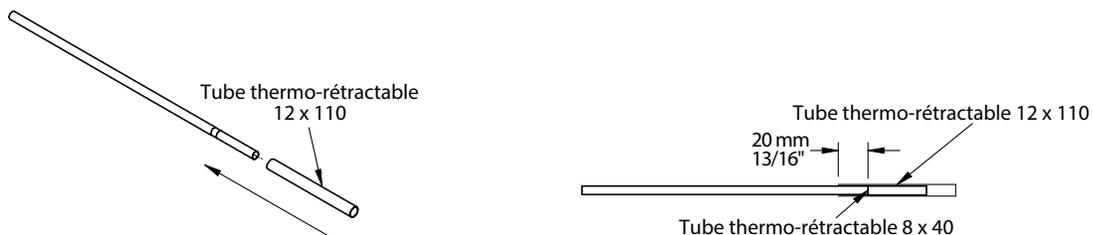
5.6 Chauffer le tube thermo-rétractable sur toute sa longueur avec un pistolet à air chaud (ne pas le surchauffer) et pendant que le tube est encore chaud, écraser doucement l'extrémité du tube sur 7 mm (5/16") à l'aide de pinces d'électricien jusqu'à ce que le tube thermo-rétractable soit froid. Le tube doit demeurer visiblement scellé au moment de retirer les pinces. Si le tube ne demeure pas scellé, répéter cette étape.
