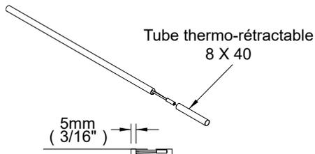
5.4 Chauffer le tube thermo-rétractable sur toute sa longueur avec un pistolet à air chaud (ne pas le surchauffer), s'assurer que le tube est bien rétréci et que du scellant déborde de chaque côté.
