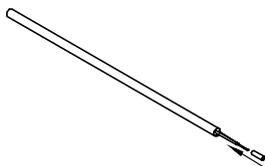
5.3 Enfiler le tube thermo-rétractable de 8 x 40 mm par-dessus les 2 fils et le superposé de 5 mm (3/16") par-dessus l'isolant extérieur du câble chauffant.
