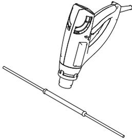
3.2 Ensuite insérer le tube 18 x 155 mm par-dessus le tube 12 x 110 mm, bien le centrer et chauffer le tube thermo-rétractable sur toute sa longueur avec un pistolet à air chaud (ne pas le surchauffer). S'assurer que le tube est bien rétréci et que du scellant déborde de chaque côté.
