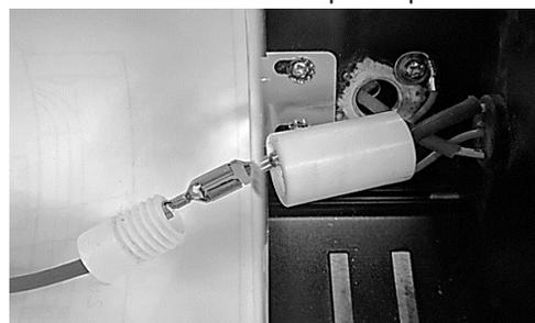
9. Réinstaller les deux pièces de métal en replaçant les fils de connexions de l'élément afin de la sécuriser à l'intérieur de l'appareil.
